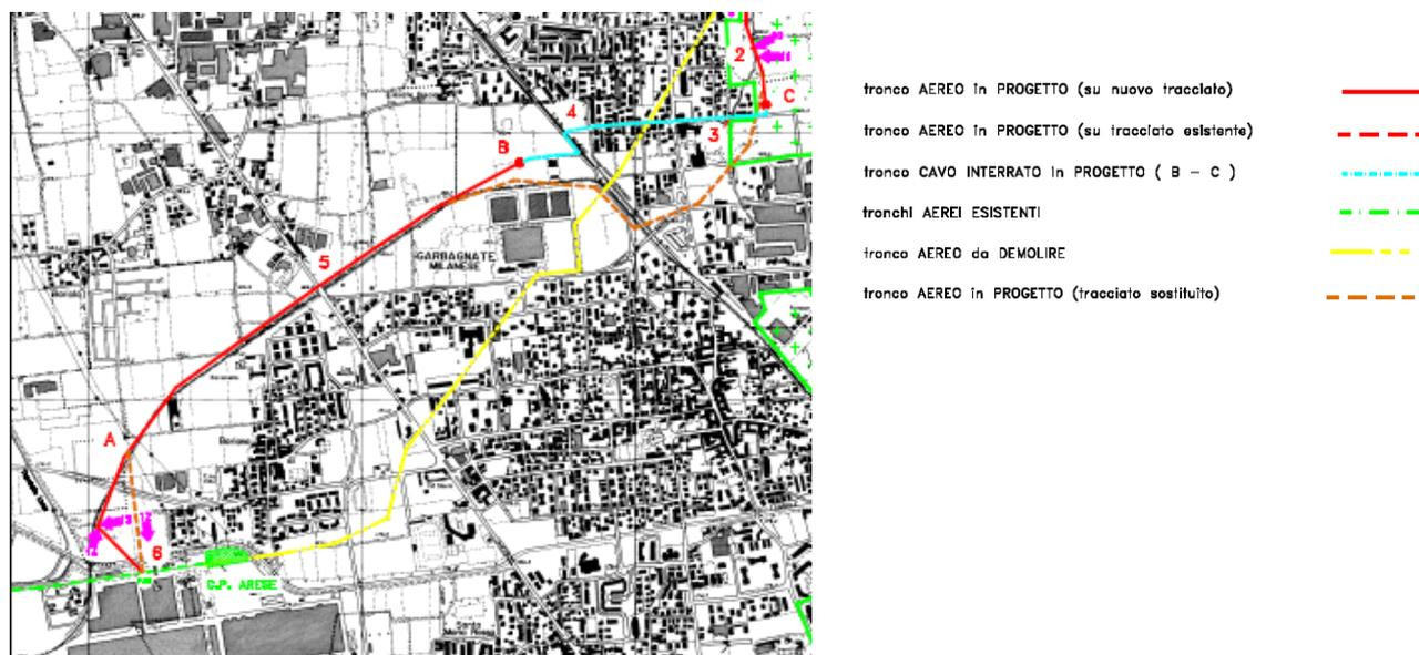
Figura B.13 - Progetto di spostamento/interrimento di un elettrodotto 132 kV
